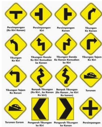
Gambar 1a. Rambu Peringatan
